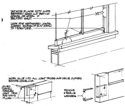
DETAIL - HALF LAP JOINT AT SASH CORNER THROUGH TENON JOINT AT SASH CORNER
