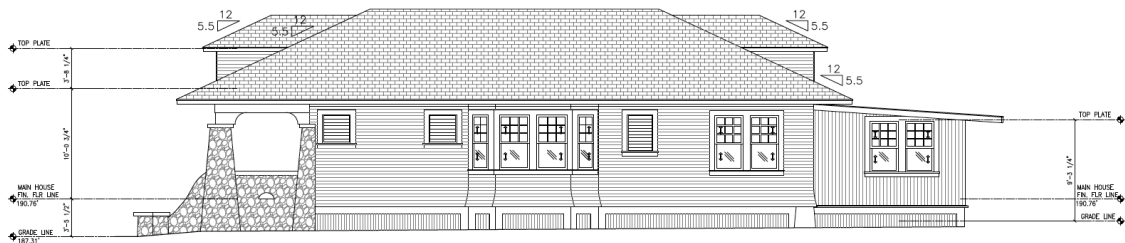
A1 RIGHT-SIDE ELEVATION SCALE: 1/8"=1'-0"
