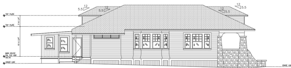
A4 LEFT-SIDE ELEVATION SCALE: 1/8"=1'-0"
